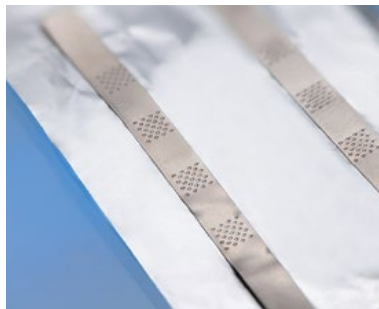
Small battery: Al tab + Al foil
